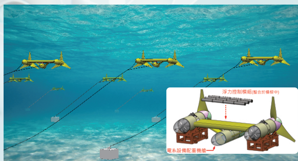
洋流發電機與海中的發電機陣列示意圖
